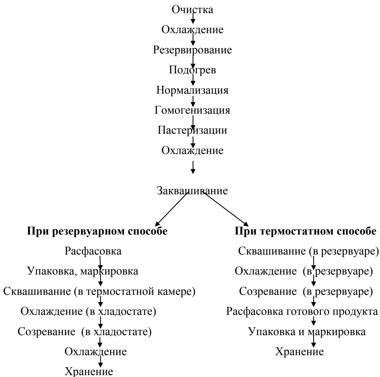
Рисунок 8 – Технологическая схема производства кисломолочных напитков
