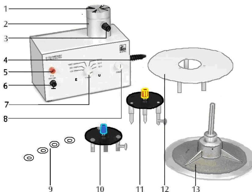
Рисунок 4.2 1- экранирующая пластина; 2- экранирующий цилиндр; 3- гнездо заземления; 4- сетевой выключатель (не виден); 5- гнездо выходного напряжения; 6 - гнездо заземления для выхода; 7 - переключатель диапазонов измерения; 8 - регулировка напряжения смещения; 9 - набор разделительных дисков из оргстекла; 10 - пластина для измерения напряжения в диапазоне 1х; 11 - пластина для измерения напряжения в диапазоне 10х; 12- пластина
