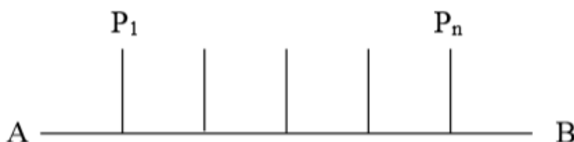
Рисунок 23 - Схема к перенесению в натуру методом перпендикуляров
