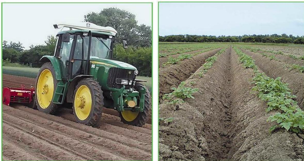
Рисунок 41. Трактор JOHN DEERE, оснащенный системой «Автопилот», производящий гребнеобразование на посадках картофеля на базе Центра точного земледелия РГАУ-МСХА имени К.А.Тимирязева и результат работы – ровные симметричные гребни.
