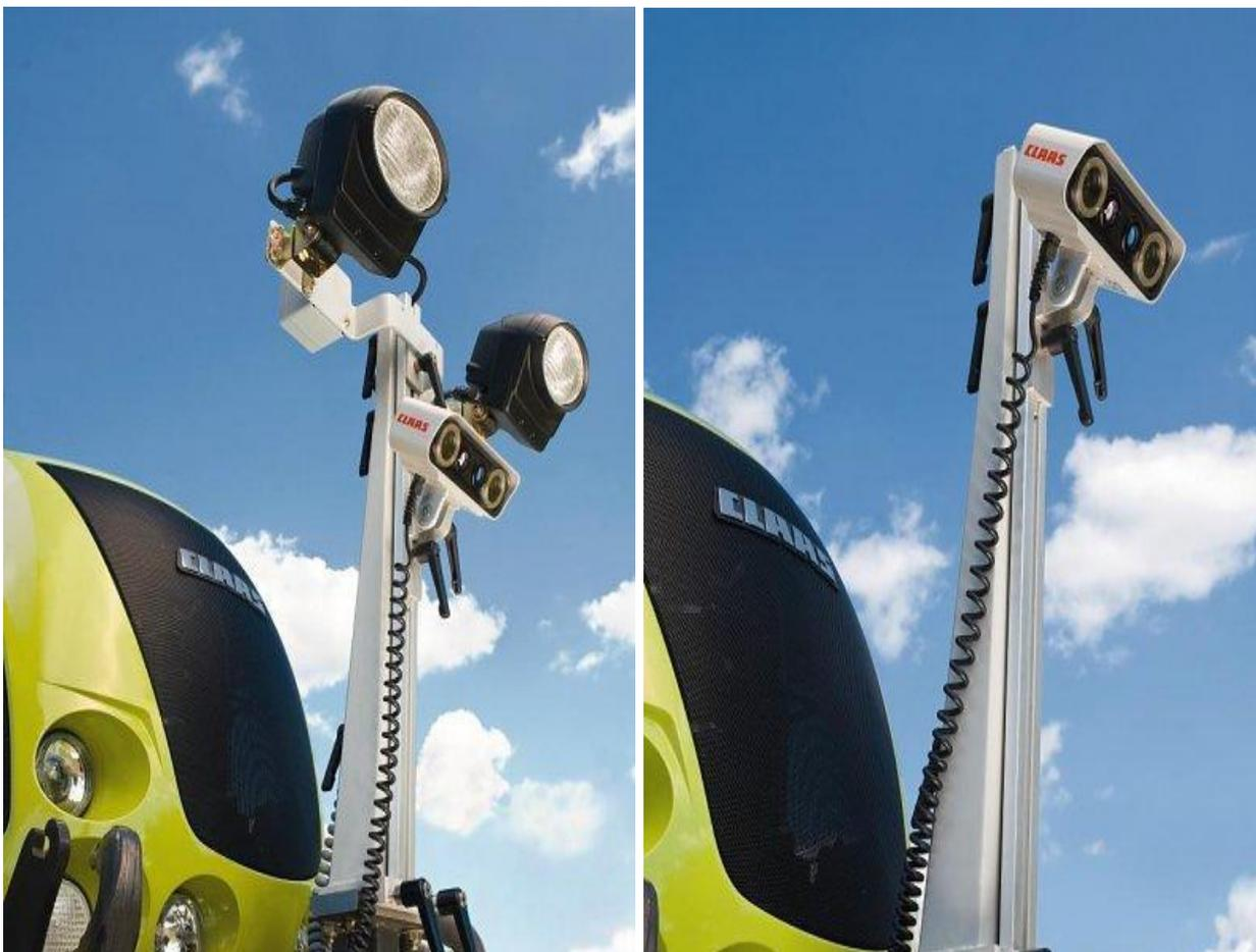
Рисунок 62. Электрооптический датчик системы Claas CAM PILOT установленный на грузах, предназначенных для увеличения сцепного веса, в передней части трактора.
