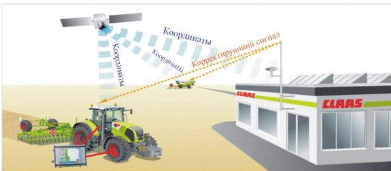
Рисунок 42. Технология RTK (Real Time Kinematic).
