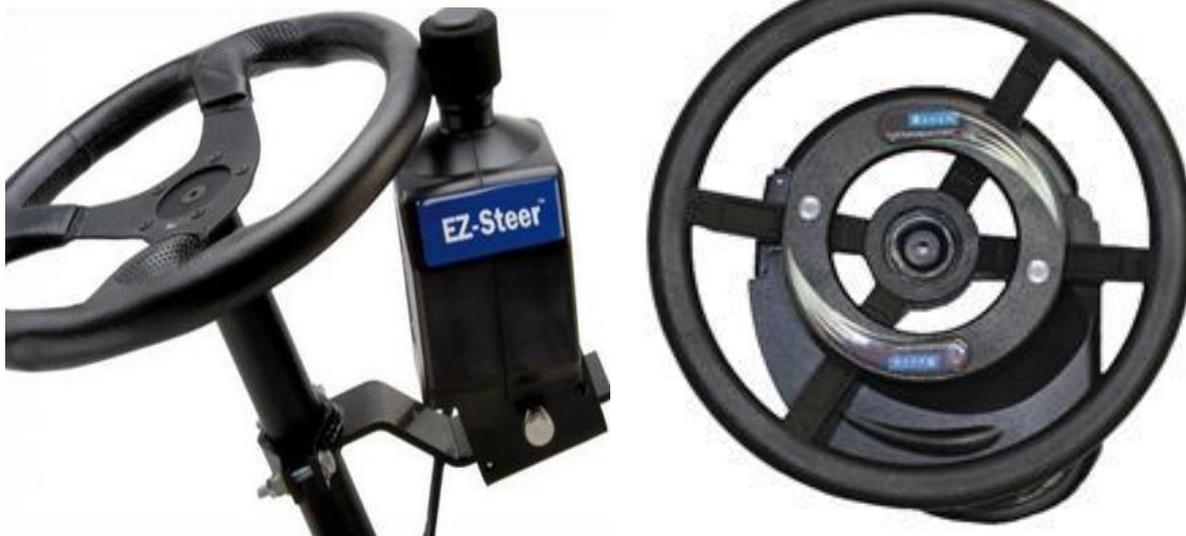
Рисунок 61. Подруливающие устройства для «механических» автопилотов, в данном случае – устройства, монтируемые на руль и не требующие вмешательства в гидравлику трактора.
