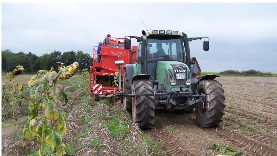
Рисунок 63. Автопилот с оптическим датчиком EYE-DRIVE (CAM PILOT) в работе.
