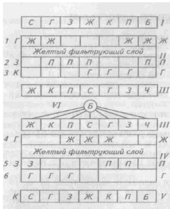
Рисунок 8 – Схема цветного фотоизображения: I – цветной объект; II – цветная фотопленка; III – цветной негатив; IV – цветной позитивный материал: 1...6 элементарные слои
